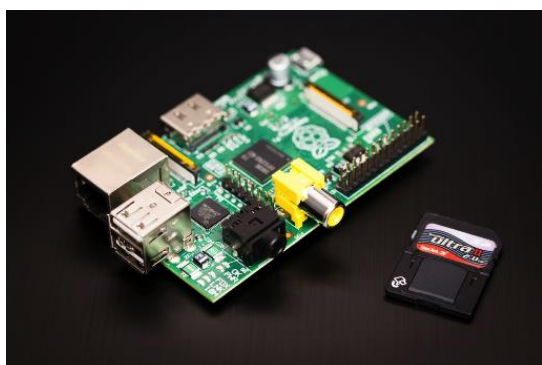
Figure 17 : carte Raspberry Pi : design et architecture (Source : raspberry.fr)
