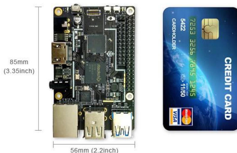
Figure 11 : architecture compacte d'une carte d'ordinateur mono-carte (Source : http://4k.com )
