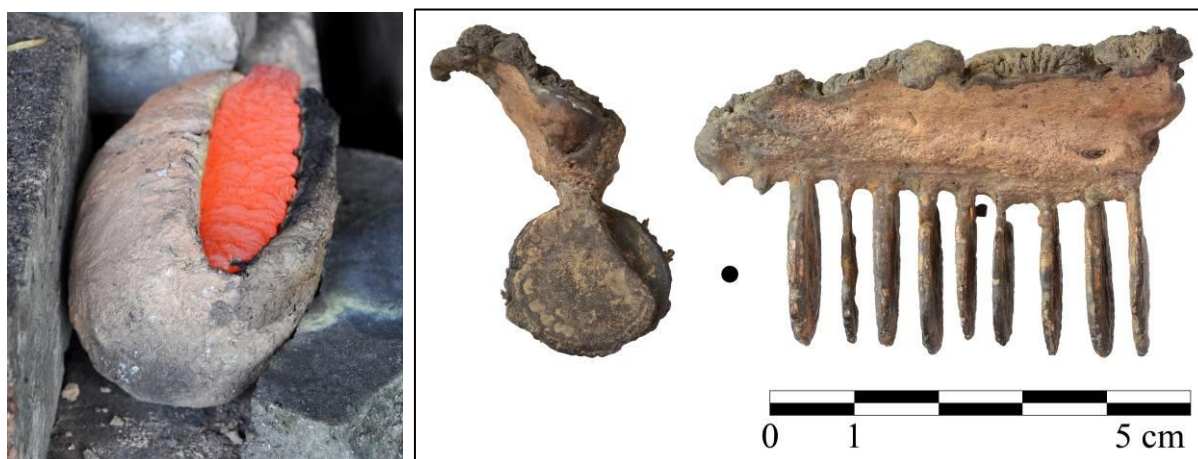
Figure 77, Potée posée de biais et chapelet obtenu (P10)
