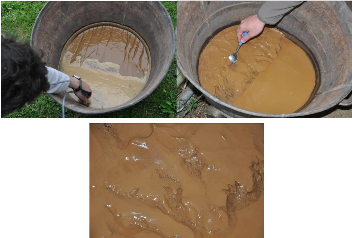
Figure 66, Haut gauche, baquet en cours de siphonage. Haut droit, prélèvement de la couche supérieure de terre. Bas, détail de la terre après décantation
