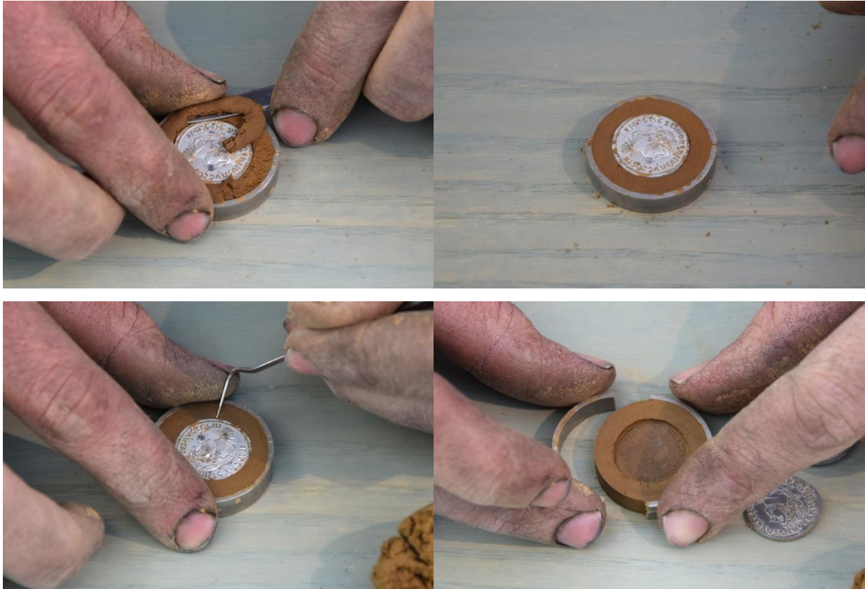
Figure 71, Modus operandi de l'élaboration des moules à empreinte unique
