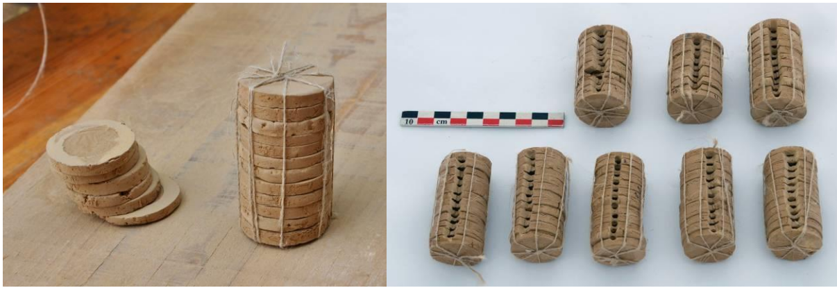
Figure 73, Piles de moules ligaturées avant et après réalisation des canaux de coulée
