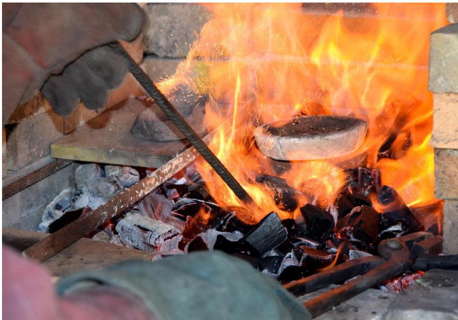
Figure 76, A droite, creuset mis au feu. A gauche, support de préchauffe des potées (ici, moule d'essai)
