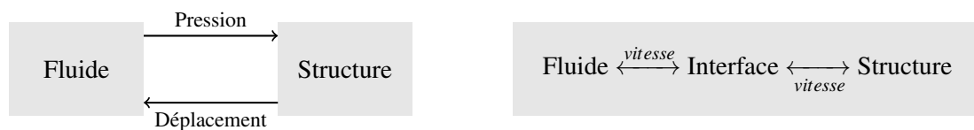
FIGURE 1 – Formulation partitionnée versus Formulation monolithique
