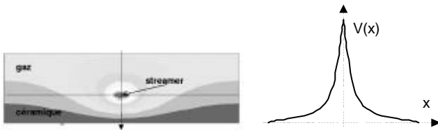
Fig. 4 : répartition du potentiel à la surface de l'électrode autour d'un streamer ; fonction de répartition reconstituée par la matrice d'influence
