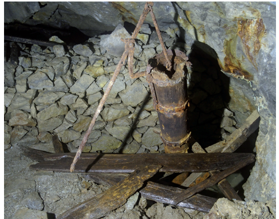
FIG. 29. Pompe manuelle en bois datée du XIX e siècle découverte dans la mine de Vallauria (Tende, Alpes-Maritimes). Cliché B. Ancel.
