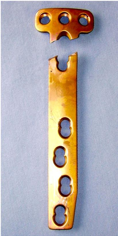
**Abb. 6 ▲** Bruch eines Plattenfixateurs (Tomo-Fix, Depuy-Synthes) durch fehlendes Besetzen des „D-Lochs“. Dies hat zu einer zu hohen Belastungskonzentration der Platte in diesem Bereich geführt und ultimativ den Plattenbruch erzeugt
