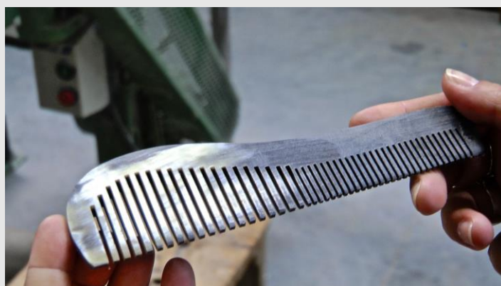
III. 6. Les étapes de finition d'un peigne : perlage, ponçage et polissage (entreprise Azéma-Bigou). © Mathilde Lamothe, 16 mai 2019.
