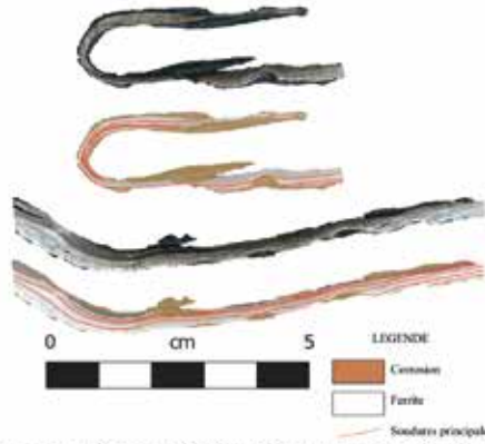
Cartographie des sections étudiées après attaque chimique au nital (3%) et dessin d'interprétation.
