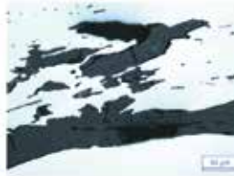
Cliché n°2 : Inclusions peu déformées, en majorité siliceuses. Micrographie M. Berranger.
