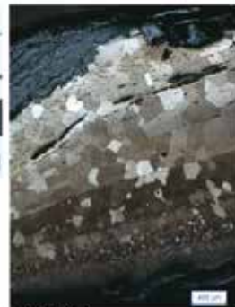
Cliché n°3 : Couches de ferrite réagissant différemment à l'attaque acide et révélant une superposition de feuilles soudées. Micrographie M. Berranger.
