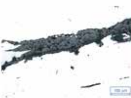
Cliché n°1 : Inclusion déformée saturée de globules de wustite. Micrographie M. Berranger.
