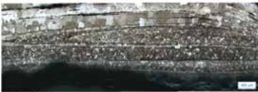
Cliché n°4 : Repli révélé par des lignes de soudures superposées. Micrographie M. Berranger.
