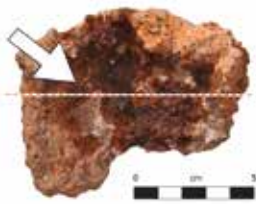
Photographie de la scorie n°125 avec indication du plan de coupe.
