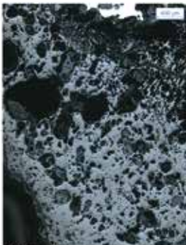
Cliché n°1 : Matrice saturée en globules de wustite. Micrographie M. Berranger.
