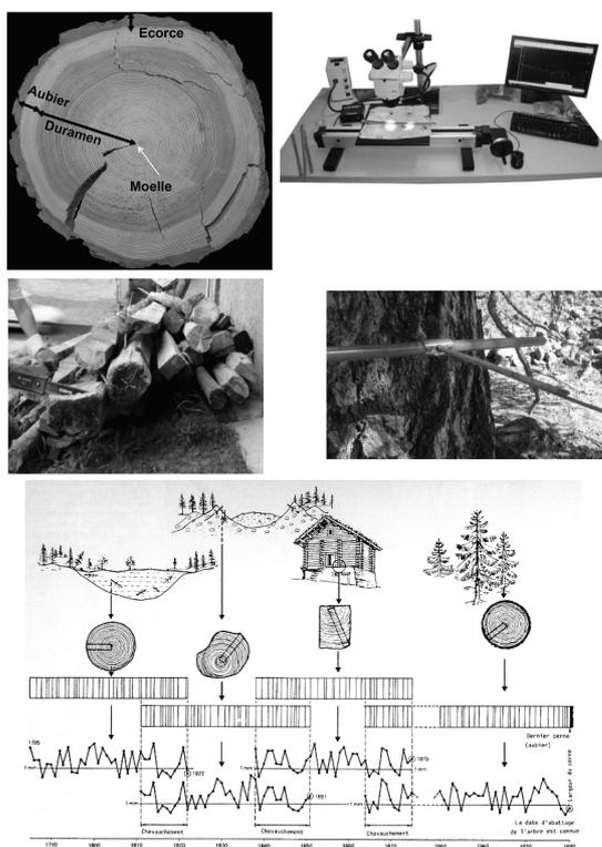
Coupe radiale d'un arbre ; loupe binoculaire et table de mesure ; bois déposé ; prélèvements à la tarière de Pressler ; schéma de la construction des référentiels.
