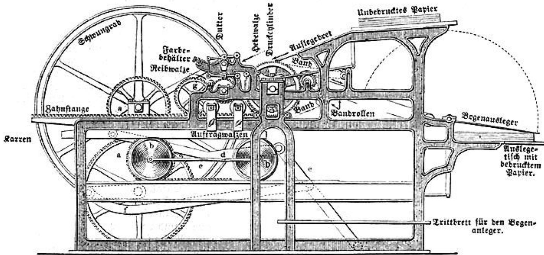
Einfache Schnellpresse. Aufriss einer einfachen Maschine mit sogenannter Eisenbahnbewegung. a Treibräder, b Karrenrollen, c Traverse oder Wagenverbindungsstange, d Karrenstange, e aufrechte Stange, f Zugstange, g Zwischenrad, daneben der Nacktzylinder für die Farbenreibung. Der Lauf des Papiers ist durch punktierte Pfeile angegeben.
