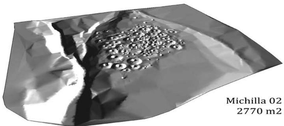
Figura 2. Representación en 3D de tres de cementerios de túmulos. Microtopografía realizada mediante un levantamiento cada 5 cm.
