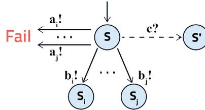
FIG. 3 – Principe de génération de test.
