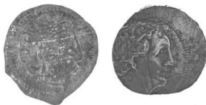
Fig. 12: Monnaies en argent avec des traces de glissement radial du métal (à gauche Melle, à droite Monnaie de Ptolémée).
