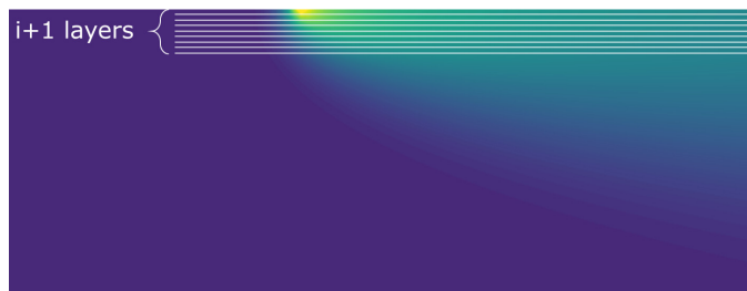
(d) Thermal increment caused by the manufacturing of layer i + 1 .
