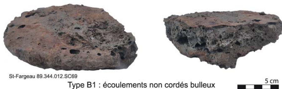
Figure n°54. Typologie des écoulements cristallisés bulleux de type B1.
