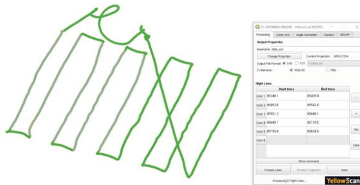
Figure n°29. Fenêtre et utilisation du plugin YellowScan, via le logiciel QGIS (version 3.6 - M. Herbrich).
