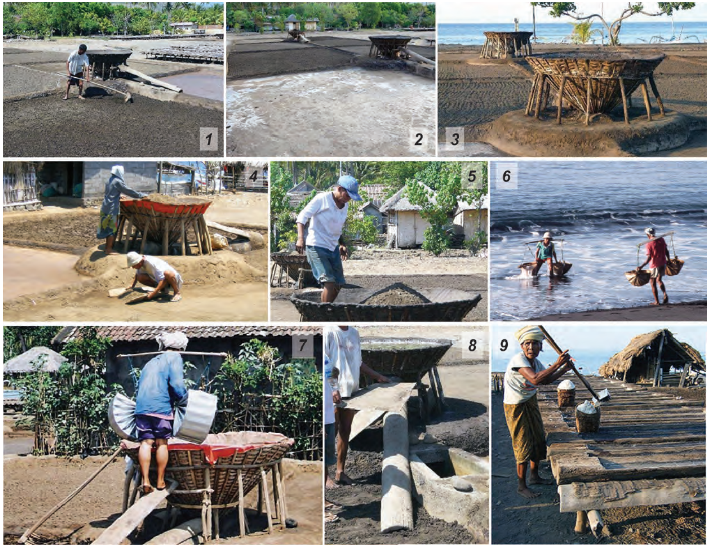
Fig. 9 - La production du sel marin sur la côte orientale de Bali, à Amed (Indonésie). 1- Le sable en haut de la plage est ratissé ; 2- Le sable retourné est saturé avec de l'eau de mer ; 3- Les paniers de filtration sont plantés à l'angle de 4 parcs ; 4- Récolte des sablons et versement dans les paniers ; 5- Le sable est tassé ; 6- Nouveaux va-et-vient vers le rivage pour puiser l'eau ; 7- Versement de l'eau de mer sur les sablons ; 8- L'eau filtrée et concentrée descend dans une fosse creusée dans le sol, ici aménagée pour être puisée sur le côté ; 9- La saumure cristallisée au soleil dans des demi-troncs d'arbre est récoltée à l'aide d'un racleur et d'une pelle (photos J. Daddy et S. Cassen).
