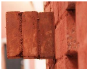
La cohésion du mortier doit permettre de coller des briques contre un mur.
