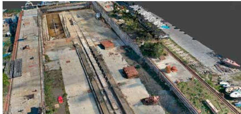
Nuage de points de la cale des chantiers de La Ciotat, 2020. © Paul Francois, LS2N.
