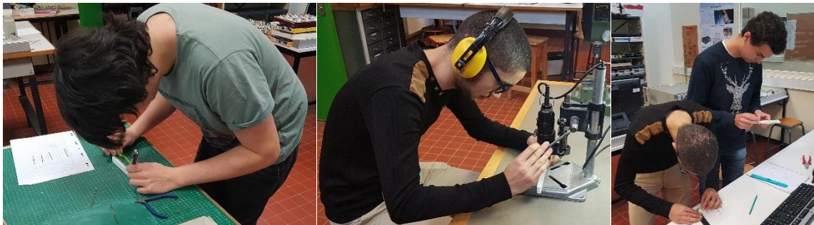
Fig.9. Quelques lycéens en cours de fabrication de l'antenne Yagi : découpage des brins, perçage du support et assemblage.
