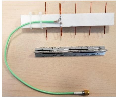
Fig.8. A gauche, matériel nécessaire pour la réalisation de l'antenne. A droite, photo d'une antenne Yagi réalisée par les lycéens.
