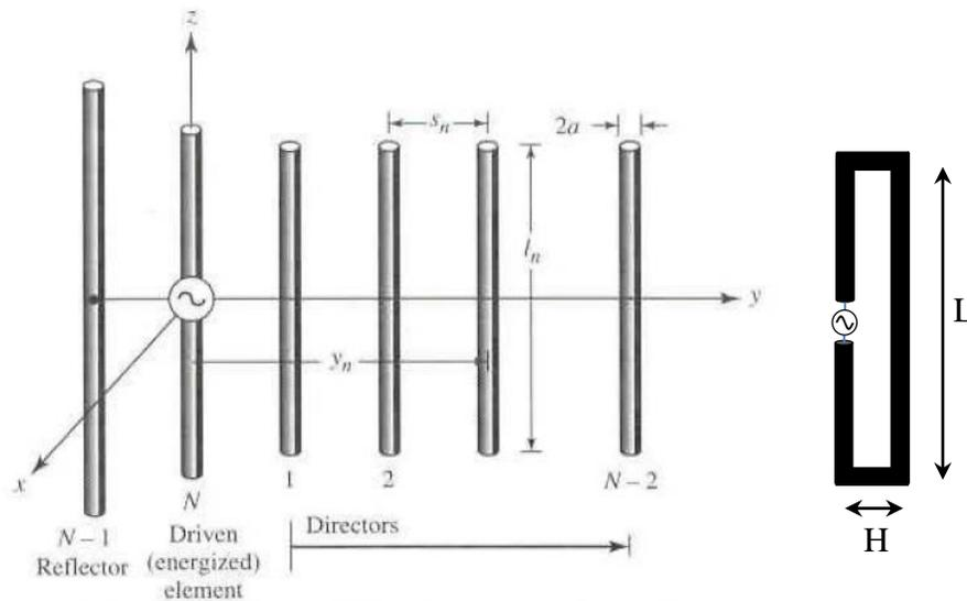
Fig.1. À droite - Constitution d'une antenne Yagi-Uda, extrait de *Antenna Theory* de C. Balanis [1], à gauche - Dimension du dipole replié servant d'élément actif à l'antenne
