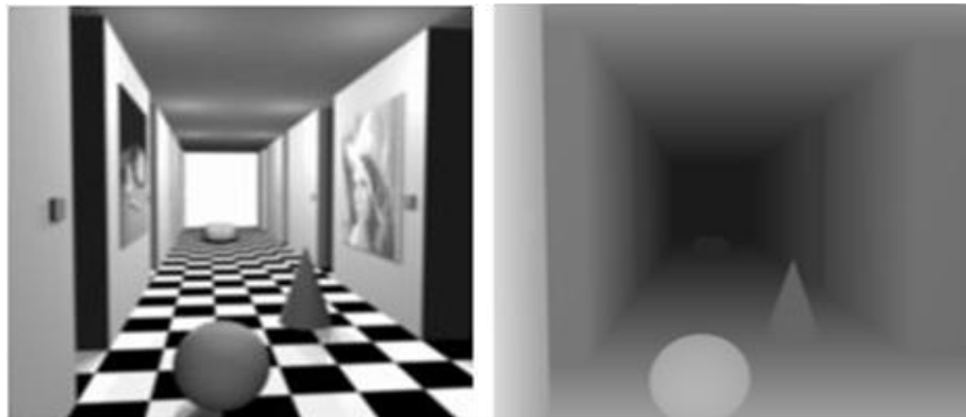
Figure 3 : A gauche une image synthétique en niveaux de gris, à droite la même image dont la luminosité (en niveau de gris) est remplacée par la distance (en réalité la disparité) convertie en intensité lumineuse.
