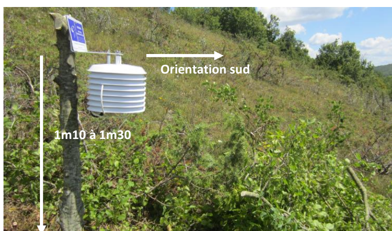
Fig. 39. Station météorologique sur un site d'étude du programme les sentinelles du climat en pelouse calcicole.
