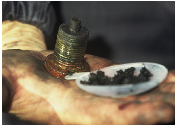
Figure 14 – Vue du pas de vis de la fusée après dépose et échantillon de poudre. Crédit photographique Olivier Pohnu.
