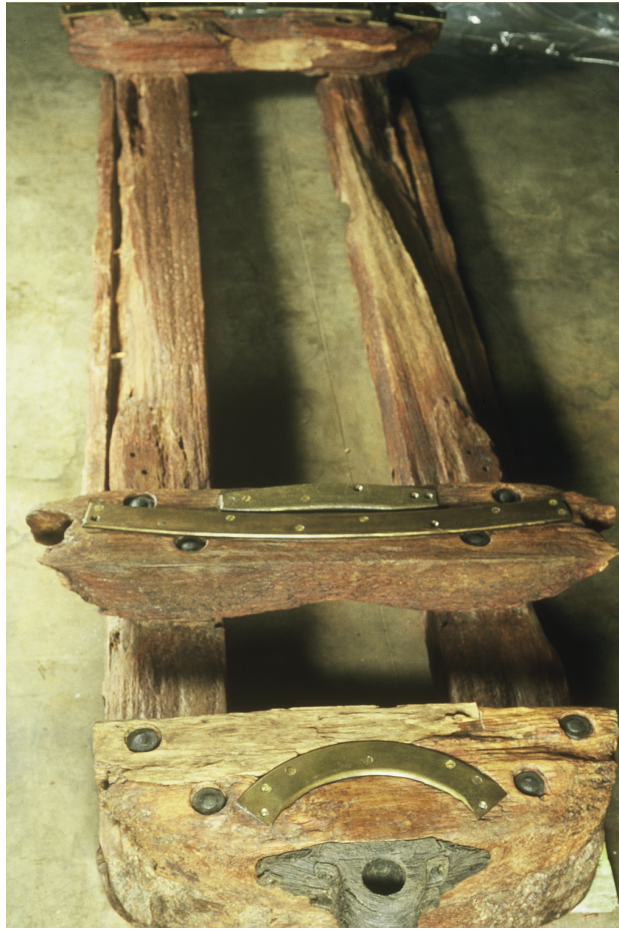
Figure 39 – Revers du châssis après conservation et réassemblage. Crédit photographique Paul Mardikian.
