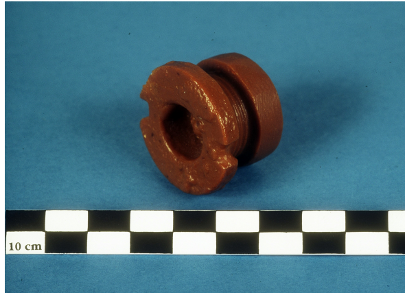
Figure 9 – Tirage en polyuréthane de la fusée permettant la fabrication de l’outil de désamorçage. Crédit photographique Paul Mardikian.
