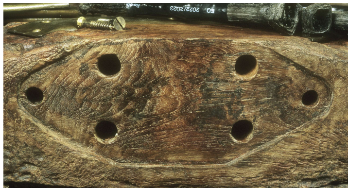
Figure 34 – Vue de l'avant du châssis montrant la partie du bois évidée correspondant à l'emplacement du renfort en fer forgé. Crédit photographique Paul Mardikian.
