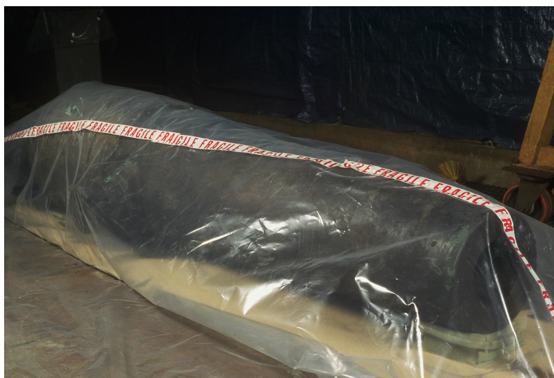
Figure 24 – Dessiccation du canon avec tamis moléculaire avant imprégnation. Crédit photographique Paul Mardikian.
