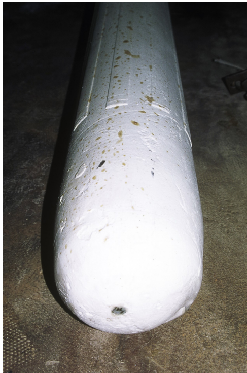
Figure 40 – Prise d’empreinte de l’intérieur de l’âme rayée du canon Blakely qui permet d’examiner avec une grande précision la chambre de combustion de cette pièce d’artillerie exceptionnelle. Crédit photographique Paul Mardikian.
