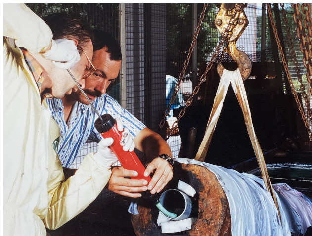
Figure 8 – Injection du silicone lors de la prise d'empreinte de la fusée. Crédit photographique Jean Michel Baud.
