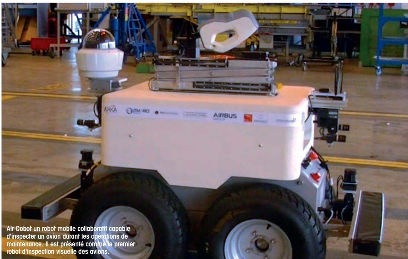
Air-Cobot un robot mobile collaboratif capable d'inspecter un avion durant les opérations de maintenance. Il est présenté comme le premier robot d'inspection visuelle des avions.
