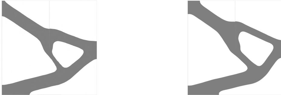
Figure 3: Forme optimisée avec l'approche "Ersatz" (gauche) et remaillage conforme (droite)
