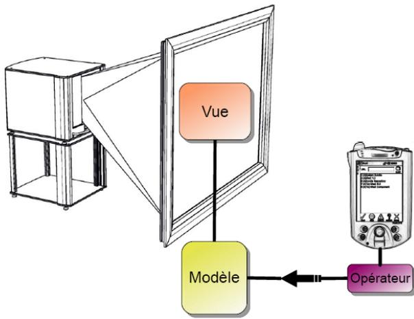
FIGURE 6: utilisation d'un PDA comme périphérique d'interaction.
