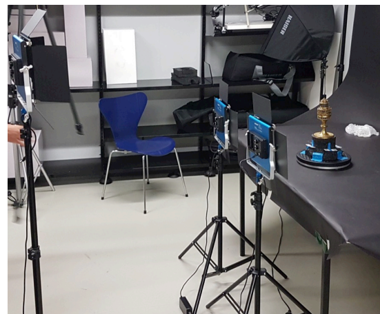
2e phase : en lumière par polarisation croisée, sur fond noir mat (papier cartonné épais) et usage de deux sources lumineuses, l'une directe (leds), l'autre par flashes avec filtres polarisés orientables
