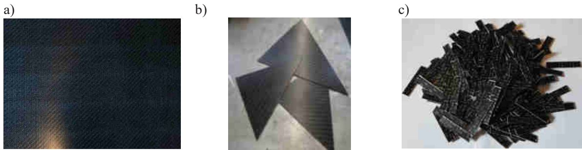
Figure 1. a) Stratifié initial, b) Déchets de production, c) grains rectangulaires.
