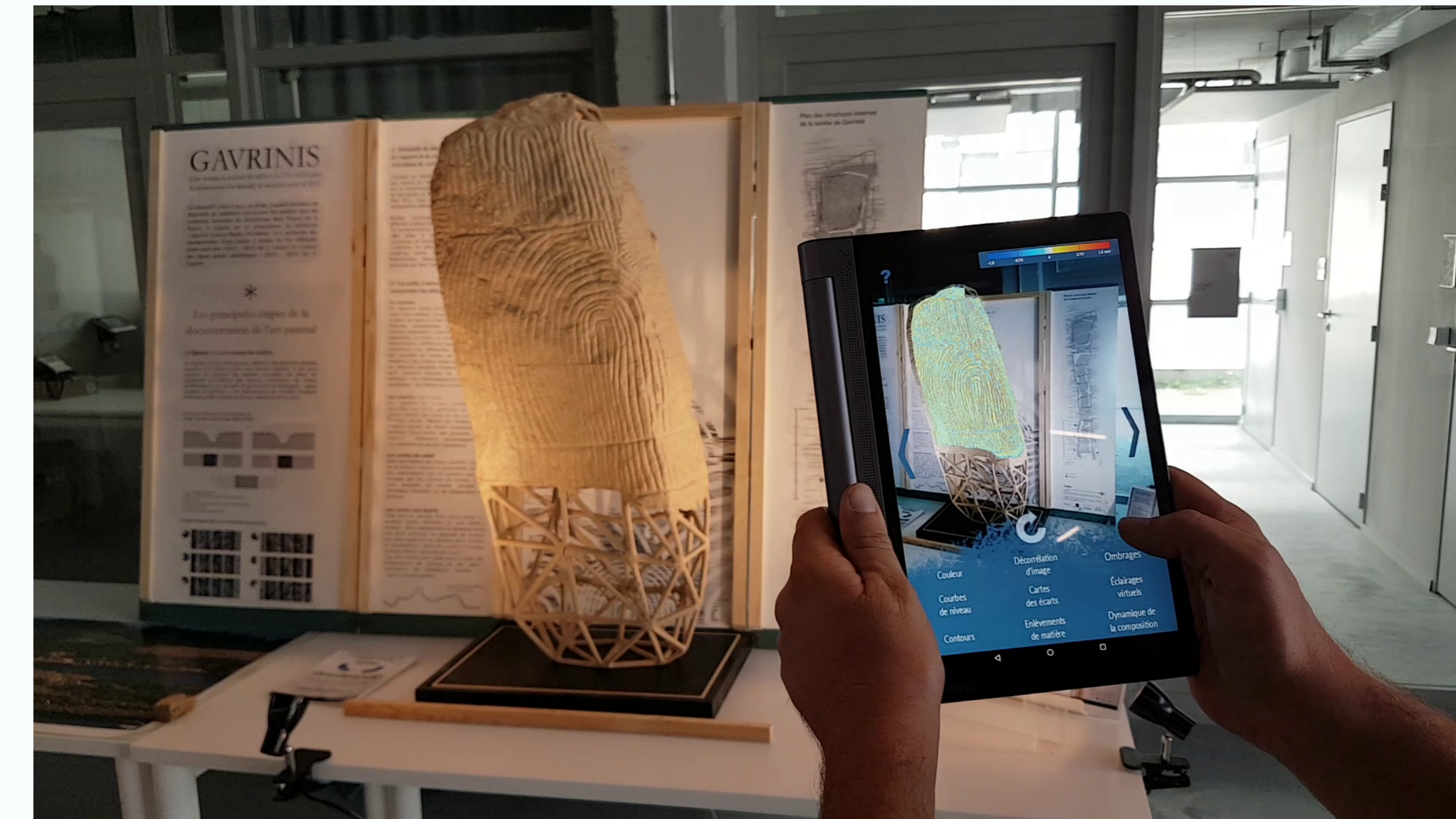
Une application en réalité augmentée permet de superposer les différentes couches d'informations sur le modèle imprimé en 3D, à l'échelle 1/3.
