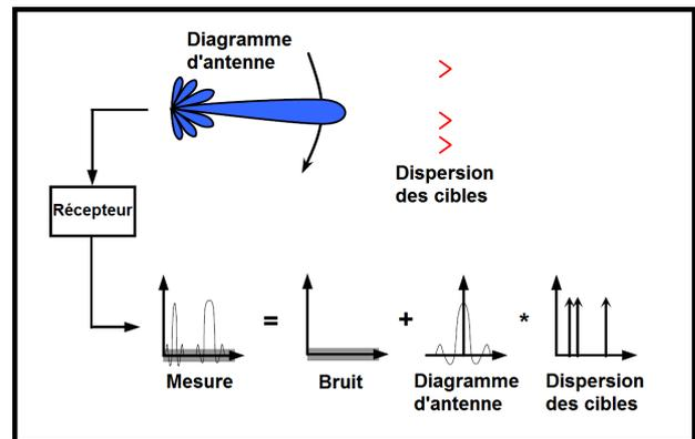
Figure 1. Configuration de mesure.
