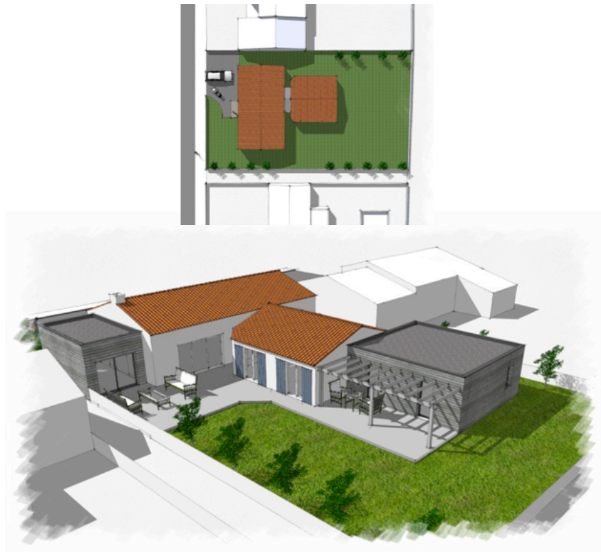
Figure 3. Projet d'extension de maison à Challans ; en haut : plan masse de l'existant ; en bas : volumétrie du projet, proposition retenue par les clients avec quelques modifications (pergola supprimée) ; dessins de l'architecte
