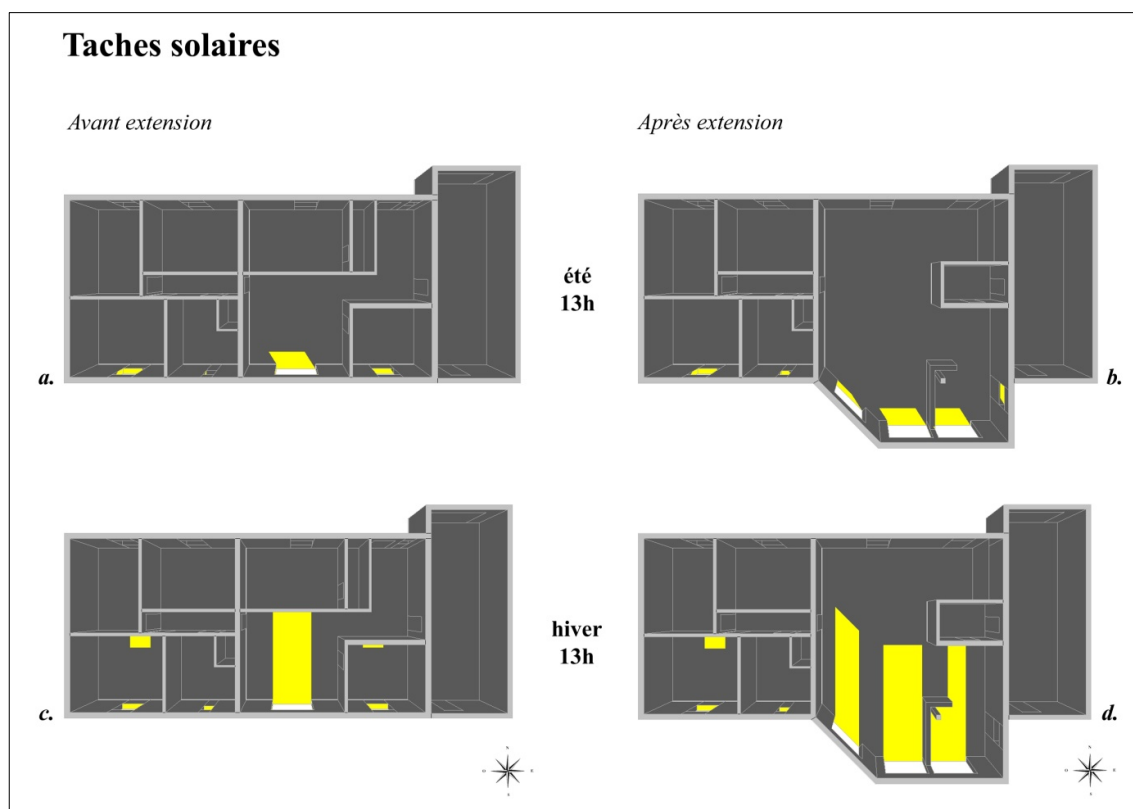
Figure 12. Planche des taches solaires été/hiver, avant/après extension
