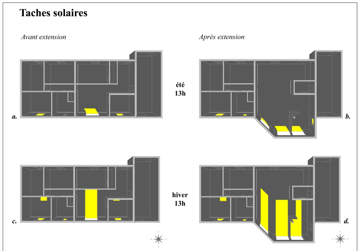
Figure 12. Planche des taches solaires été/hiver, avant/après extension
