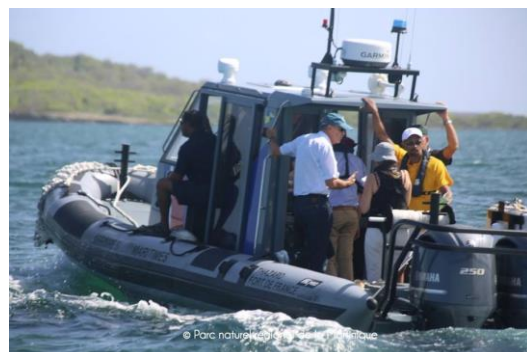
Vedette " Thazard " de la DM, de 8,75m et lourdement motorisé (2x250cv)
