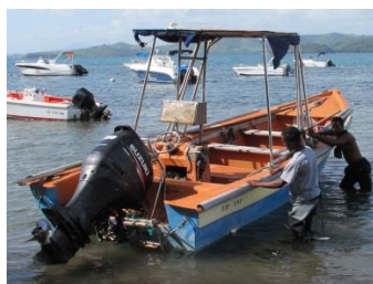
Yole de pêche " TIP TOP " de 7,2 m motorisée (150cv) et équipée d'une table traçante et d'un treuil
