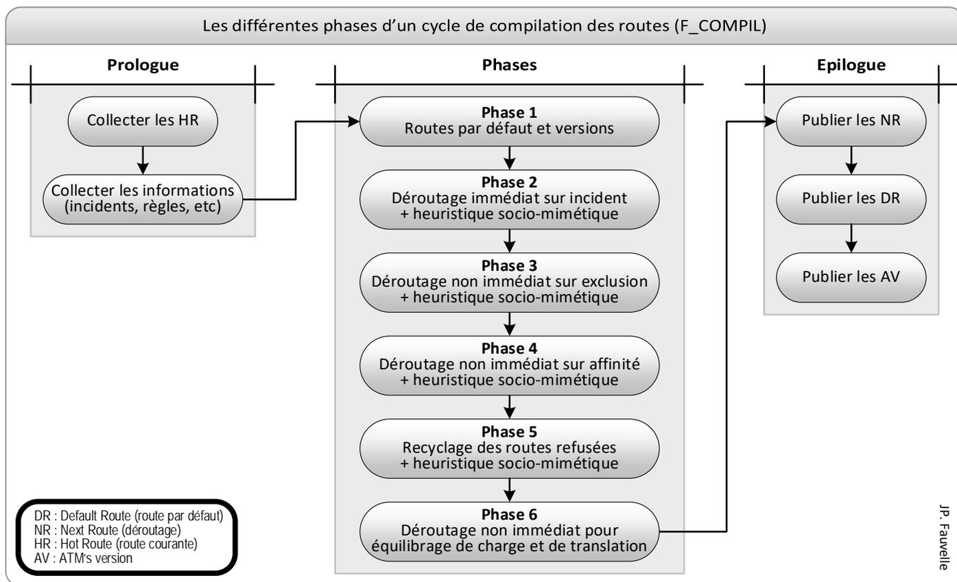
Figure 6 – Les différentes phases d'un cycle de compilation.
