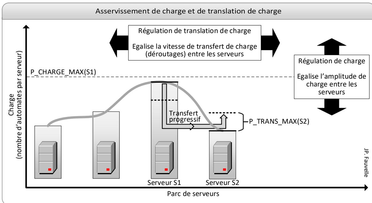
Figure 7 – Asservissement de la charge et de la translation de charge.
