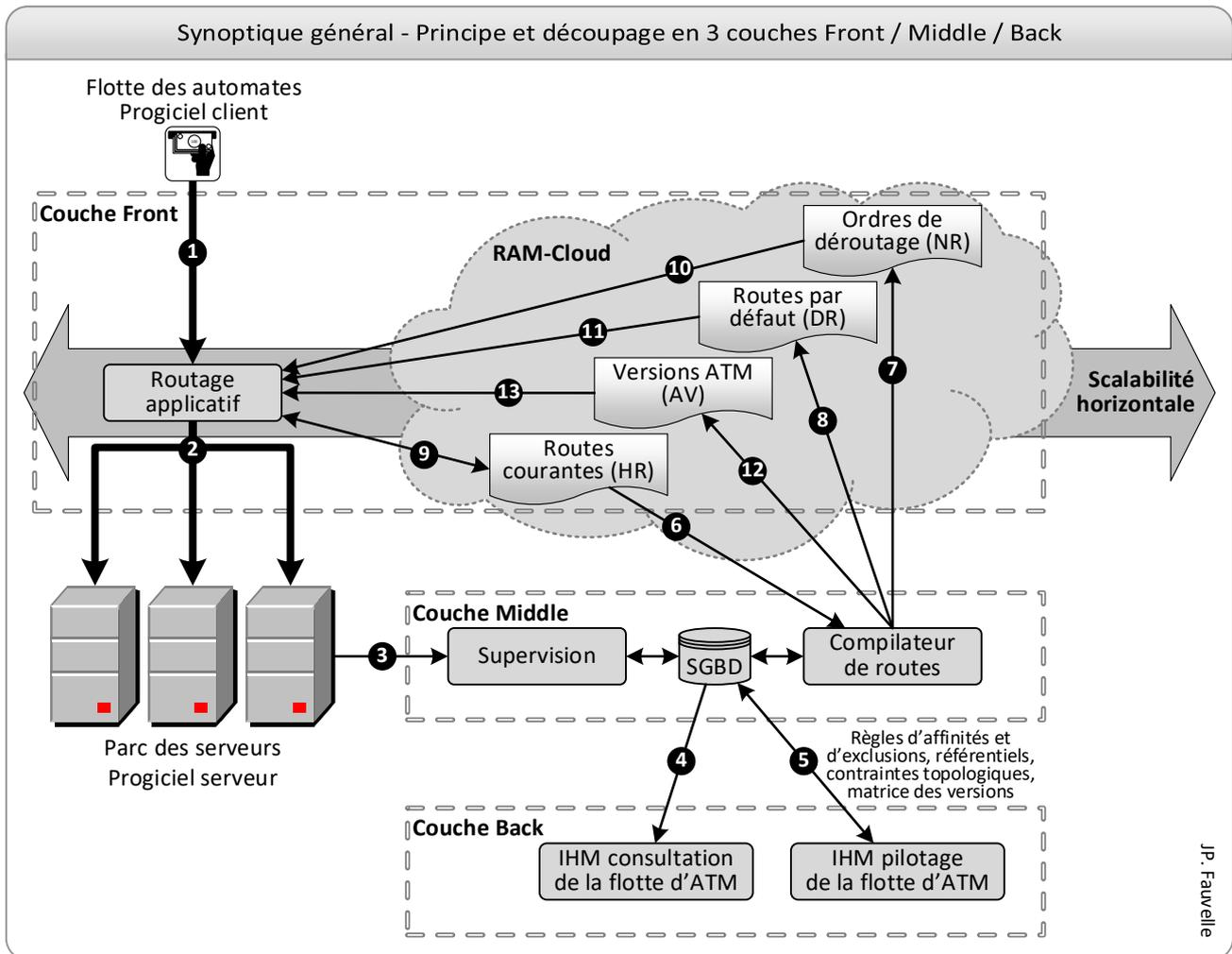
Figure 2 – Synoptique général, principe et découpage en 3 couches.
