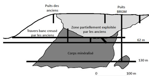
Fig. 4 : Coupe schématique de la mine de Plélauff
