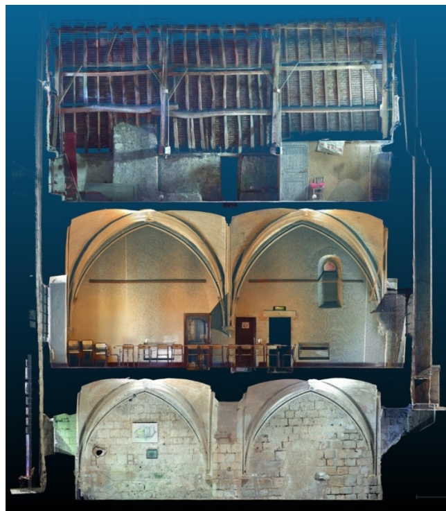
Figure 11 : Coupe longitudinale du bâtiment 2 obtenue grâce au nuage de points créé au scanner 3D (D. Morleghem)
