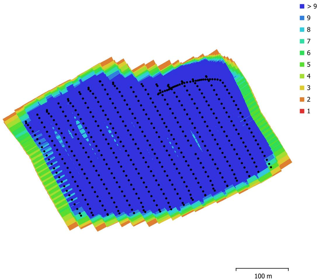
Fig. 1. Emplacements des caméras et chevauchement des images.
