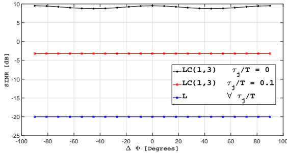
Fig.2  $SINR_{LC(1,3)}$  et  $SINR_L$  en fonction de  $\Delta\phi$  avec symboles QPSK pour SNR = 10dB et INR = 30dB.
