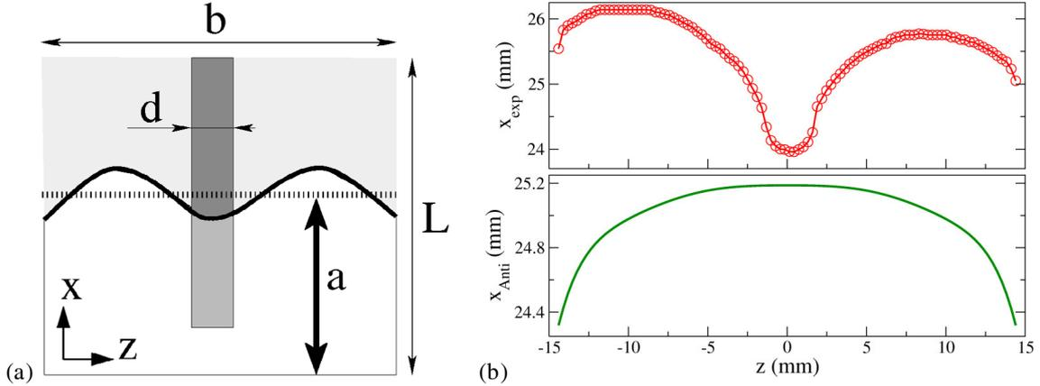
**Fig. 2.** (a) Schéma d'une fissure d'interface interagissant avec un défaut de taille contrôlée. (b) Dessus : position expérimentale d'une fissure interagissant avec un défaut. Dessous : position d'une fissure obtenue par éléments-finis dans un milieu homogène équivalent dont la courbure provient du couplage anticlastique.
