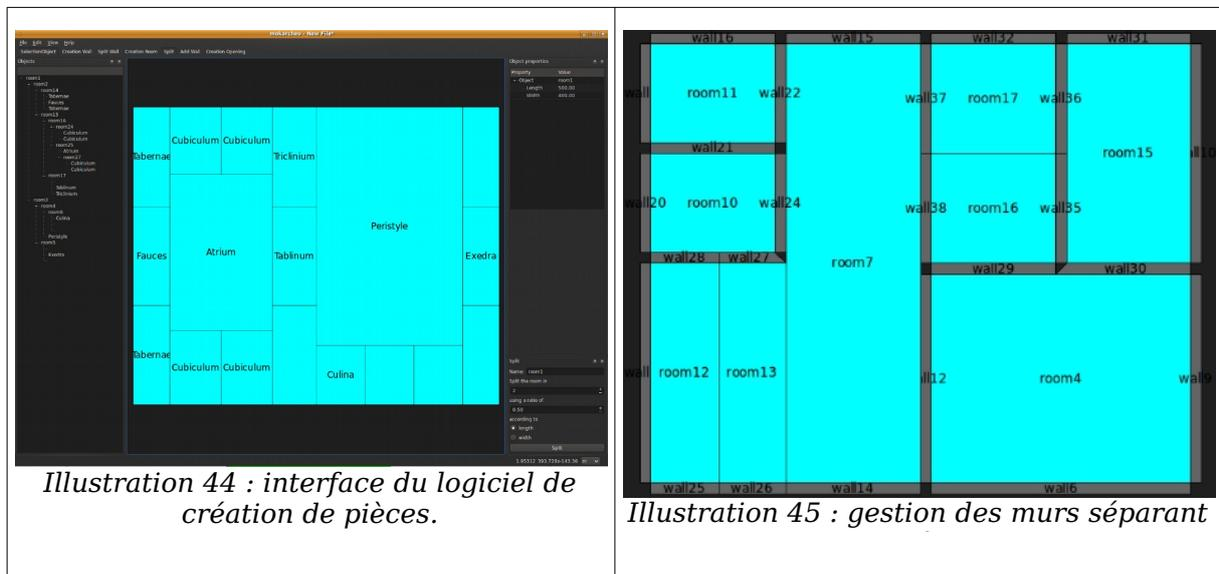
Actuellement, ce mécanisme limite la forme des pièces à des quadrilatères. J. Mauger et A. Dupas travaillent sur une version améliorée permettant de construire des pièces de forme quelconque séparées par des murs d'épaisseur variable, en ajoutant des contraintes de positionnement permettant d'assurer une certaine cohérence dans la modélisation, en cas de modification d'un paramètre tel que l'épaisseur d'un mur par exemple.
