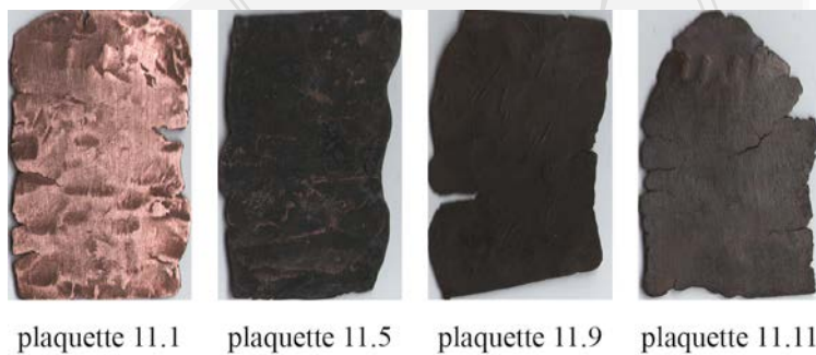
Fig. 8. Couleurs du "bronze de Corinthe" non patiné (plaquette 11.1) et patiné (plaquettes 11.5, 11.9 et 11.11) (© J. Devogelaere).
