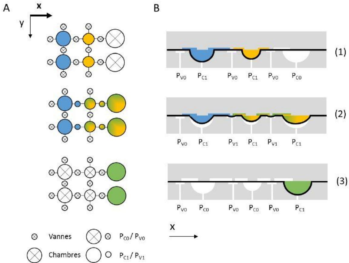
Figure 2 : Mélange entre deux chambres en X. Vue du dessus (A) et vue en coupe (B) [6].
