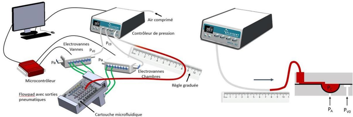
Figure 3 : Schéma du banc expérimental complet (à gauche) et simplifié (à droite).
