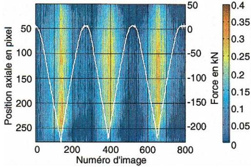
**Figure 1.** Evolution au cours du temps du profil de température de l'axe médian de l'éprouvette (en abscisse 1s = 6,25 images et en ordonnée de gauche 270 pixel = 80 mm). Courbe blanche en surimpression : évolution de la charge.
