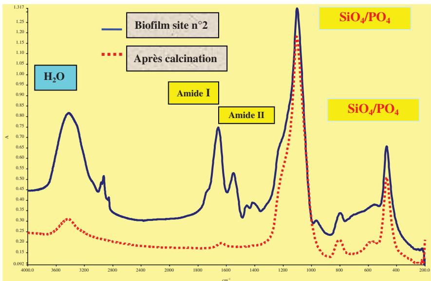
**Fig. 5.** Spectres IR, avant et après calcination, du biofilm n° 2 (évacuation de lavabo).
