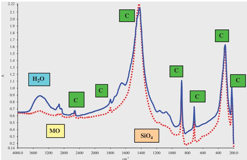
**Fig. 9.** Spectres IR, avant et après calcination, de biofilm de lavabo sans usage de dentifrice.
