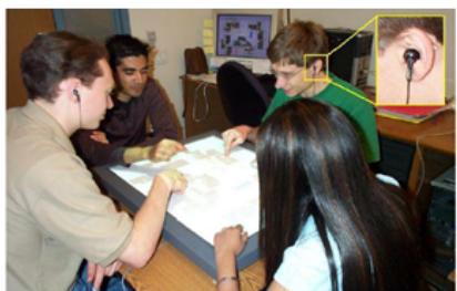
FIGURE 10: Interaction naturelle et collaborative : quatre personnes partageant une table multitouche, recevant chacune des données auditives sur des canaux individuels [33].
