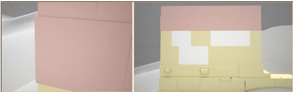
Figure 12 : La façade Est du British Museum présente un dépassement de plusieurs centimètres entre le lit d'attente de l'Assise A 1 et le lit de pose de F1.
