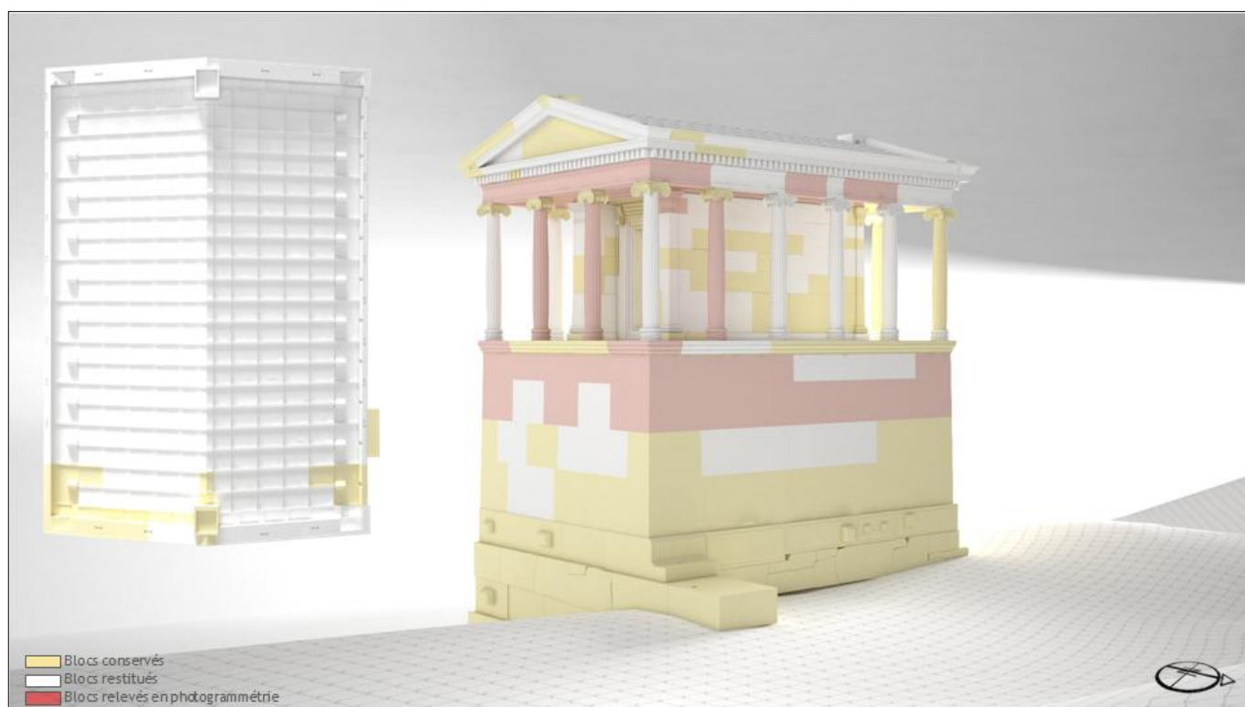
Figure 32 : Restitution de la toiture en marbre du Monument des Néréides.
