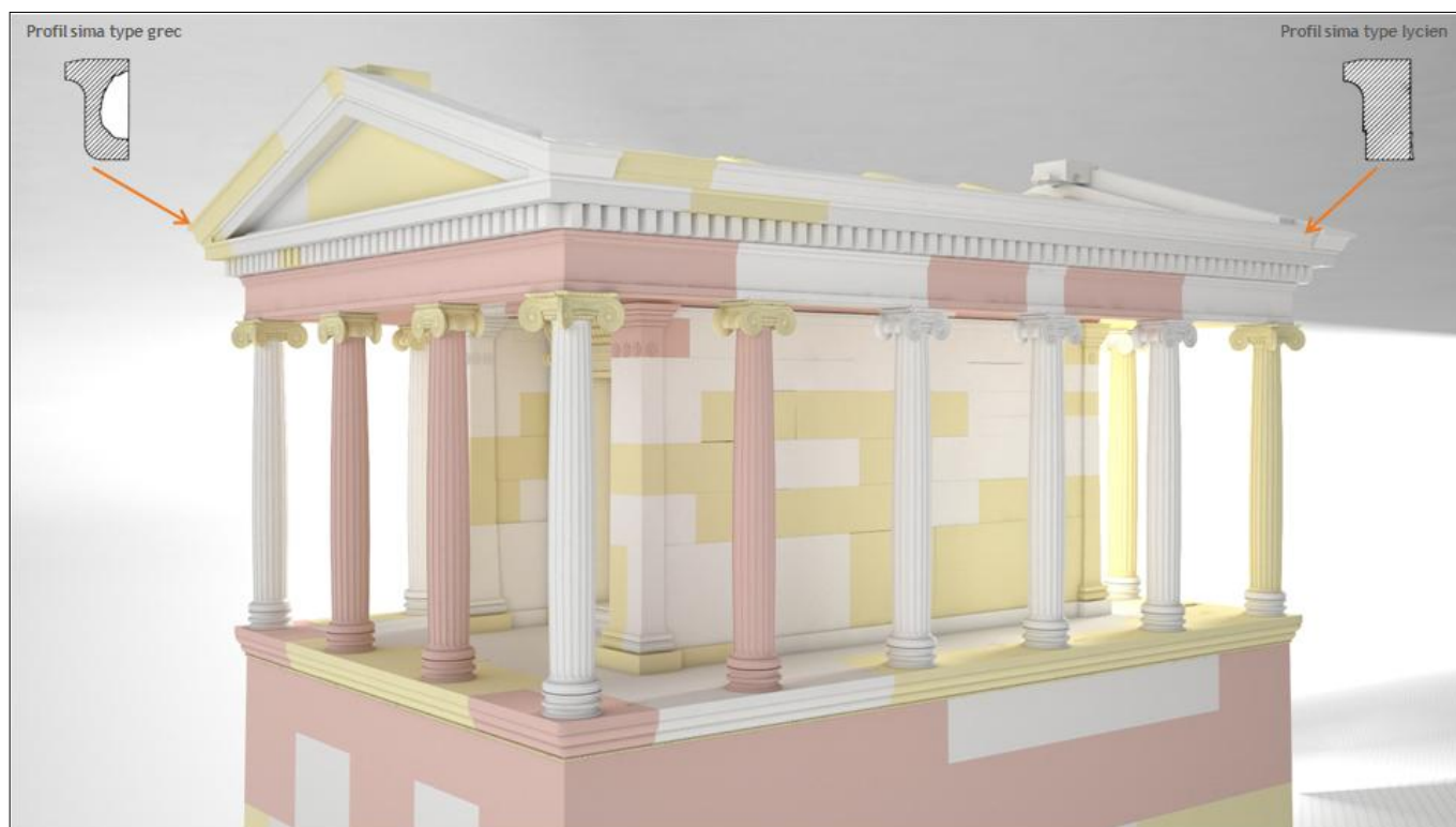
Figure 30 : Restitution des deux types de simas (lycienne à gauche, grecque à droite).
