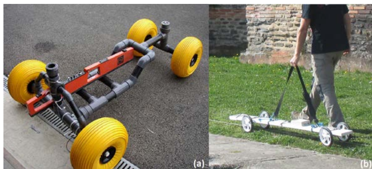
FIGURE 1 – Exemples de réalisations de chariot : (a) avec appareil EM GEONICS EM38-MK2 (photo Cerema) et ergonomique ; (b) avec appareil EM Geophex GEM-2 (photo L. Darras).
