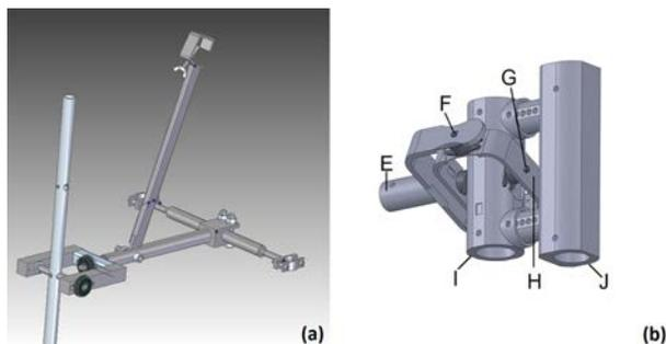
FIGURE 3 – Représentations mécanique du système d’auto-verticalisation imaginé par des étudiants (a) (CAO INSA-Lyon) et du prototype réalisé (b) (CAO L. Darras).
