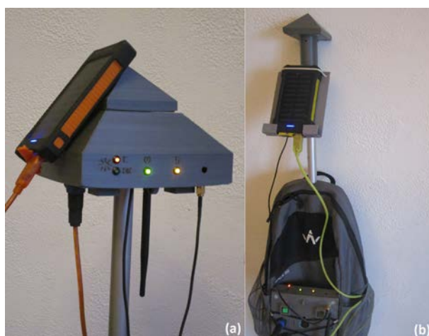
FIGURE 4 – Stations GPS RTK « KheoPS » base fixe (a) et mobile avec antenne déportée fixée sur un sac à dos (b) (photo L. Darras).
