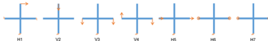
Figure 5. Représentation schématique des 7 modes de chargement unitaires pris en compte
